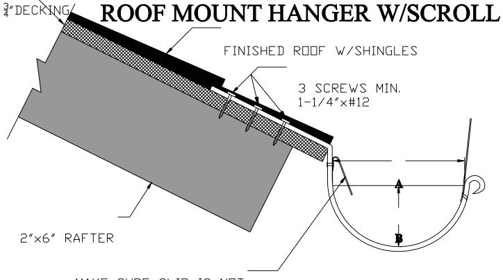
MAKE SURE CLIP IS NOT FOLDED LOWER THAN BACK OF GUTTER
